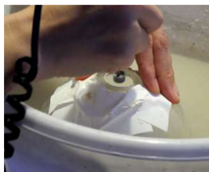
ガラスシェードのソケットを 付ける為の作業。 割れないように... そっと...
