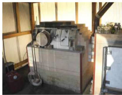
灼熱の工房の中には 1000℃以上になる溶解炉と 約500℃になる除冷炉がある
